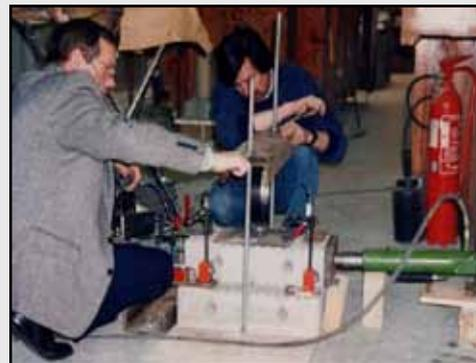
Essai de cisaillement bloc sur bloc
